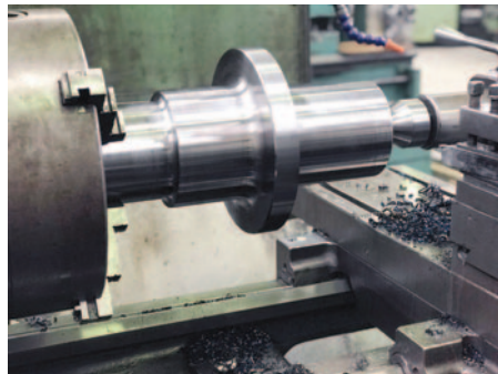
ΚΑΤΑΣΚΕΥΗ ΑΞΟΝΑ ΠΡΕΣΣΑΣ
